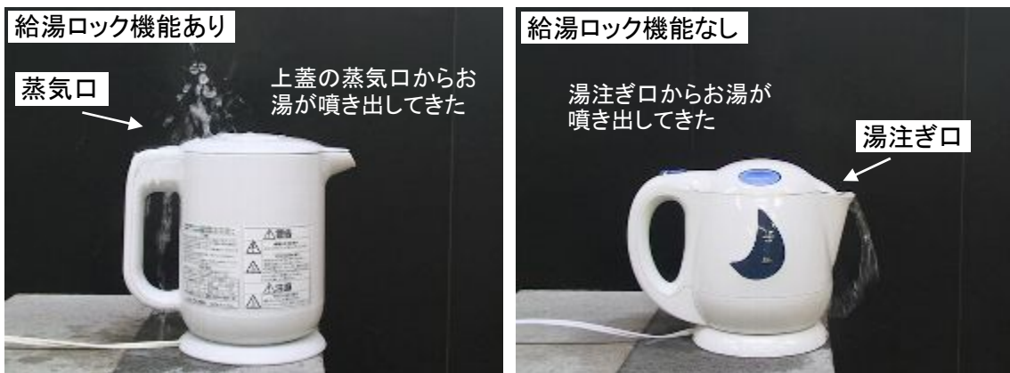
(写真2) 満水目盛以上の水を入れたときにお湯が噴き出す様子
