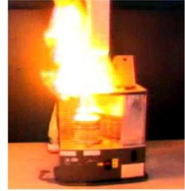
カートリッジタンクから漏れた灯油が引火しました(再現実験)
