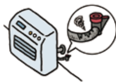
石油ファンヒーターの中で空気が通るホースが劣化してひびわれている
