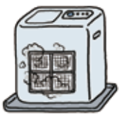
石油ファンヒーターの空気の入り口が、ほこりで詰まっている
